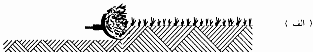
شکل ۳-۱۳ - مراحل ساخت راه‌های جنگلی با بستر طبیعی
